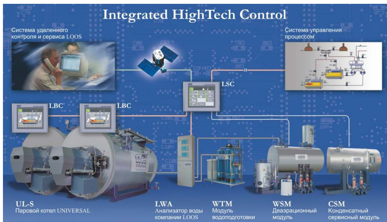
Рисунок 3: Современная паровая котельная установка компании ЛООС ИНТЕРНЭШЕНЕЛ с полностью автоматизированным
